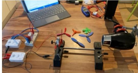
Nimm nun **einen** der Rotoren aus Plastik mit 3 Rotorblättern, fixiere ihn **vorsichtig** auf dem Motor und schalte den Fön auf **Stufe 1** und **Kaltluft**.
